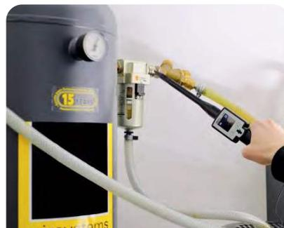
用聚焦管及聚焦头扫描泄漏区域,直至找到准确的泄漏点。
