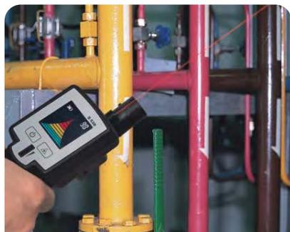
用激光指示器对准可能的泄漏点。显示屏可显示泄漏等级。
