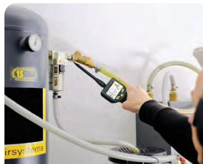
如果需要, 可用聚焦管及聚焦头扫描泄漏区域, 直至找到准确的泄漏点。
