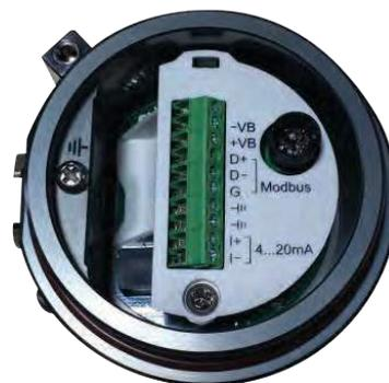
接线室内带端子标识的螺丝接线端子
