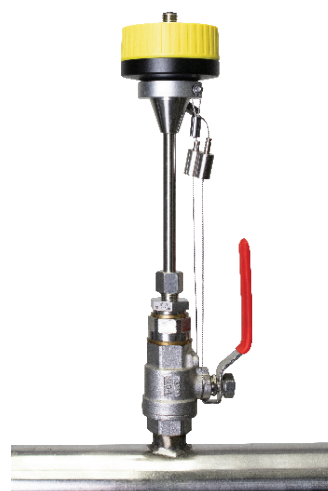
S402配备一条由钢丝制成的安全绳, 以防止拆装设备时设备弹出
