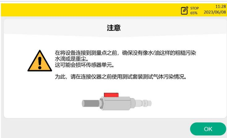
初始化完成后，出现 **注意** 界面，提醒用户使用测试工具，避免传感器因污染而损坏。
