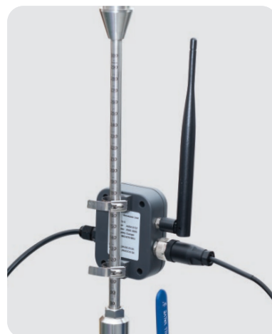
传感器测量杆安装
